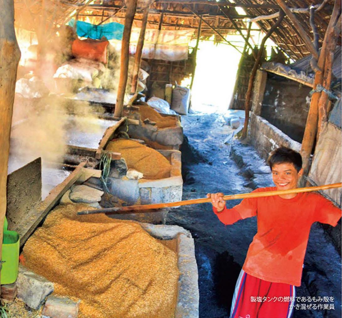
製塩タンクの燃料であるもみ殻をかき混ぜる作業員
