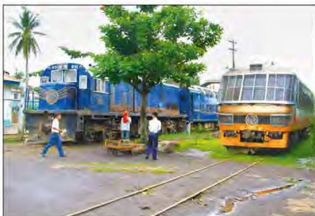
ナガ駅の引込み線内。寝台列車の機関車の前面の足回りは踏切事故に備えて、装甲車のような頑丈なつくりだった。
