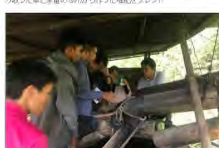
トゥブライ町の木酢液を作る装置。出来上がった木酢液は、希釈して土壤改良に使用する。ラ・トリニダード町では木酢液の原料にヤシ殻を使用。木材の伐採が禁止されているため、原料に木を使うのは難しい
