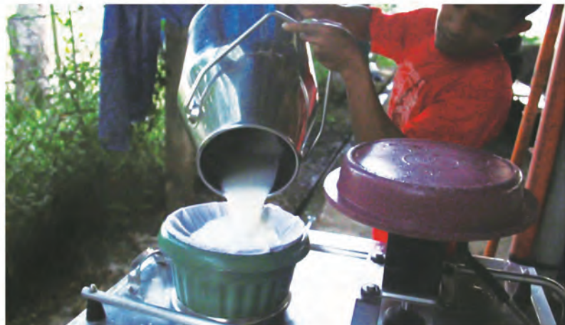
搾りたての牛乳をマイナス5度以下で冷却保存し、その後70度で約20分低温殺菌する。
